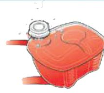
Jamais tente abrir a tampa com o motor em temperaturas elevadas, espere esfriar o motor para abrir a tampa.
