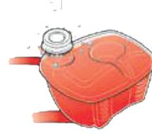
Jamais tente abrir a tampa com o motor em temperaturas elevadas, espere esfriar o motor para abrir a tampa.
