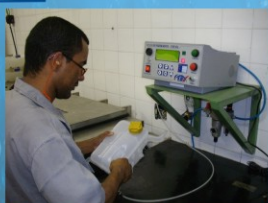
Teste de estanqueidade
